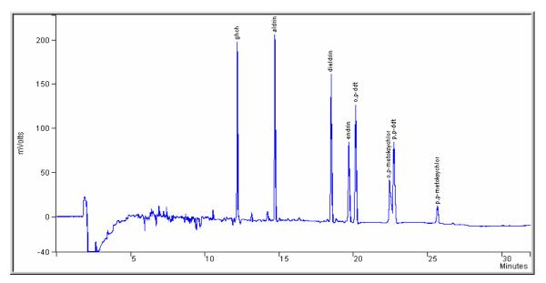
Figure 1. GC Chromatogram Of Standard Compounds. Retention Times: ?HCH 12,160 min, aldrin 14,691 min, dieldrin 18,487 min, endrin 20,138 min, o,p-DDT 22,506 min, o,p-methoxychlor 22,710 min, p,25,643 min, p,p-methoxychlor 25,783 min.
