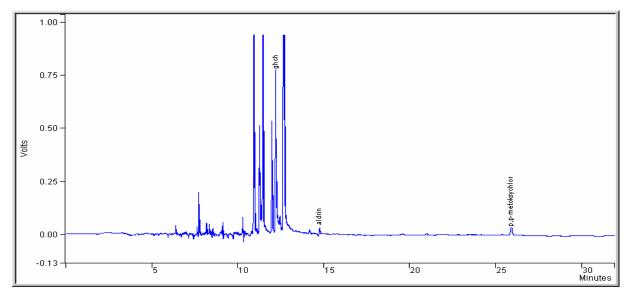
Figure 3. Chromatogram Of Heather Honey. Retention Times: ?-HCH 12,160 min, aldrin 14,691 min, dieldrin 18,487 min, endrin 20,138 min, o,p-DDT 22,506 min, o,p-methoxychlor 22,710 min, p,25,643 min, p,p-methoxychlor 25,783 min.
