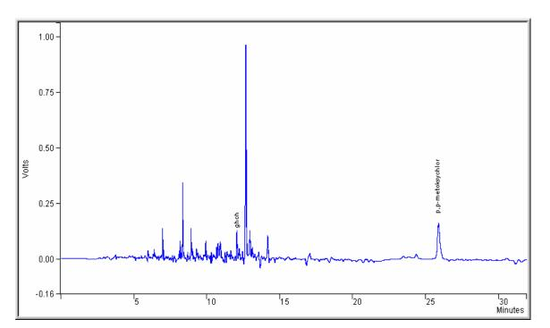
Figure 2. Chromatogram Of Buckwheat Honey. Retention Times: ?HCH 12,160 min, aldrin 14,691 min, dieldrin 18,487 min, endrin 20,138 min, o,p-DDT 22,506 min, o,p-methoxychlor 22,710 min, p,25,643 min, p,p-methoxychlor 25,783 min.
